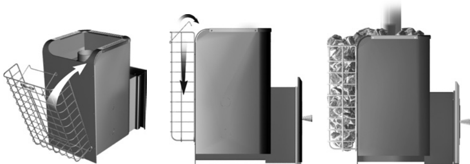
Рисунок -8. Установка сетки-каменки на печь.
